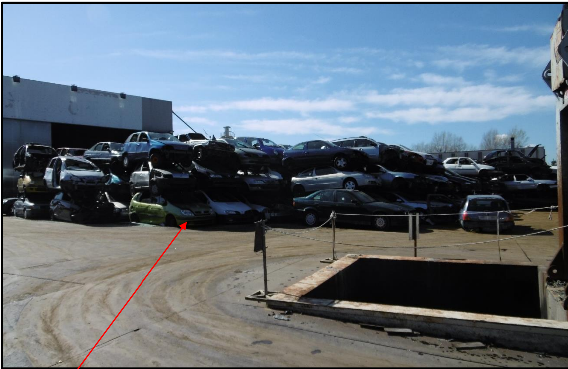
Carcasse in attesa di pressatura per formazione "Pacco"
