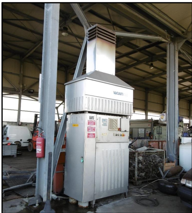
Vacumgas dispositivo per bruciare Gas Serbatoi
